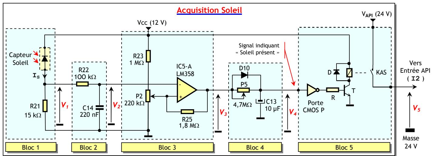
1- Le bloc 1 est un convertisseur courant/tension, qui permet d'obtenir aux bornes de la résistance R21 une tension image de l'intensité lumineuse.
