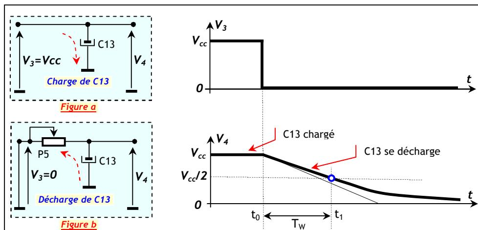
La loi d'évolution de  $V_4$  est de la forme suivante, où  $t_0$  représente l'instant du début de la décharge :
