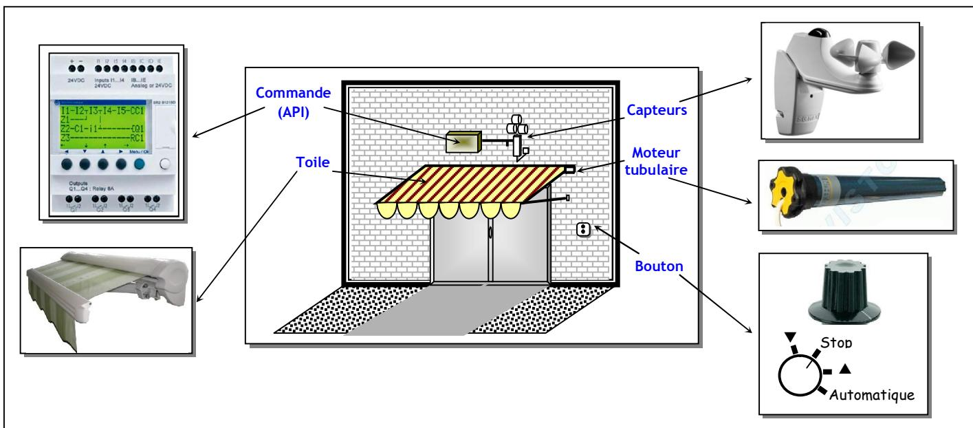
Le schéma complet de la commande du système est donné à la page 9. Pour être traitées par l'API, les informations Vent/Soleil ainsi que les commandes manuelles doivent être adaptées aux niveaux de tensions acceptables par l'API.
